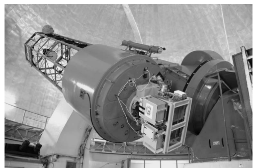
図3 188 cm望遠鏡に取り付けられたISLE.
