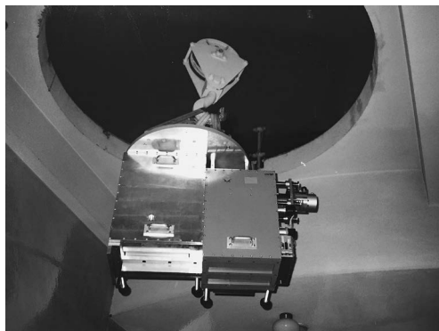
図1 188 cmドーム内のクレーンでつり上げられるOASIS。左半分が未塗装だった頃。
