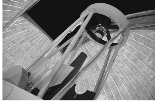
図8 OAOWFCの外観。鏡筒中央部の黒く細長い構造物はクライオスタットである。
