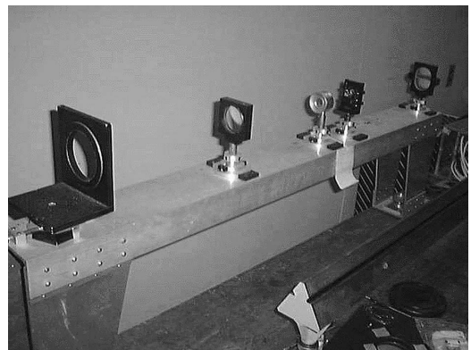
図2 写真観測用ポラリメータ。
