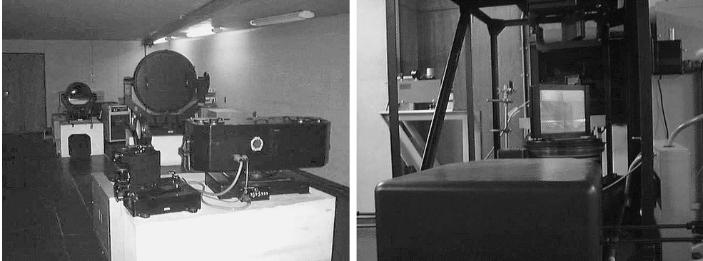
図1 左: 分光器室のコリメータミラー (左), エッセルグレーティング用の大きなカメラミラー (中央, 蓋が閉まっている) とカメラ (右の大きな箱). 右: 回折格子 (中央) とエッセルグレーティングのプレディスパーザ用透過グレーティング (上, 鉄骨の下に取り付けられている).
