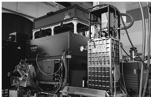
図2 極限補償光学装置SCEXAOとCHARIS. すばる望遠鏡のナスミス台の上に設置されている。ナスミス焦点は写真の左側にある。
