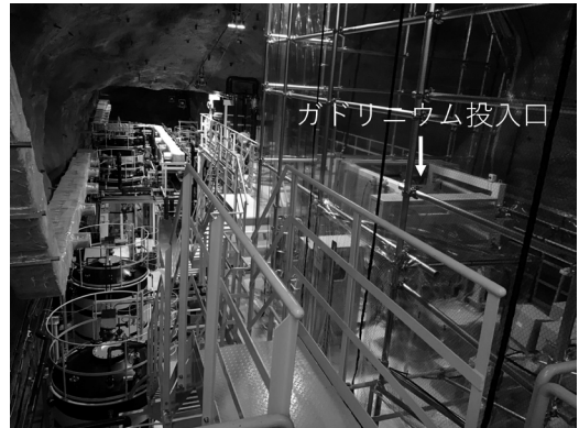
図7 SK-Gd用の新しい水循環装置。右にガドリニウム投入口が見える。
