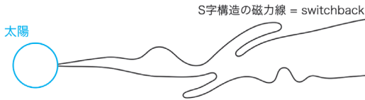
図4 太陽近傍の太陽風の磁場構造. 放射状の背景磁場にアルペーン波状の磁場擾乱が乗っているような磁場構造が理論的に予想されていましたが実際の観測ではS字構造 (switchback) が至る所で観測されました.
