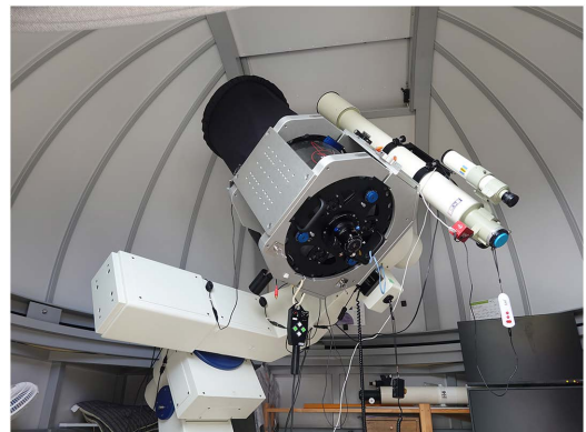
図2 観測室内の望遠鏡 片持ちフォーク式赤道儀に35 cm カセグレンと10 cm 屈折を搭載。
