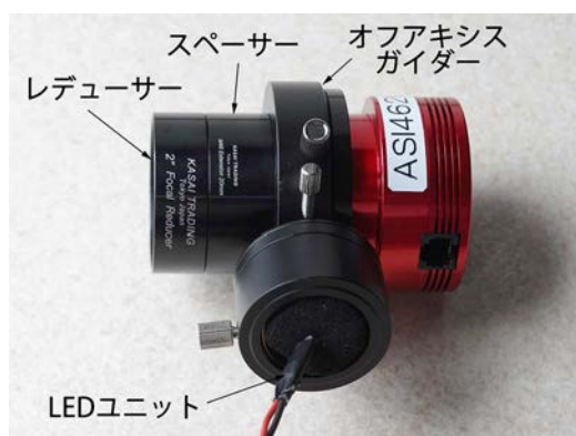
図5 (6326) Idamiyoshiによる恒星食の観測に使用したカメラ。スペーサーは縮小率調整のため使用。
