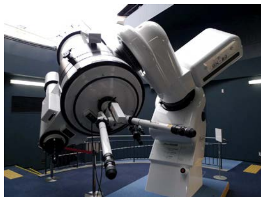
図4 天文台内の口径80 cm望遠鏡。デュアルワンダーアイの2本の接眼部が手前に伸びている。
