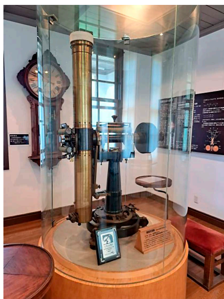
図2 初期の緯度観測に使われた眼視天頂儀1号機。ドイツ・ヴァンシャフ社製で、木村榮が使った最初の望遠鏡である。2020年度に関連する観測施設とともに日本天文遺産に認定され、現在は木村榮記念館に展示されている。
