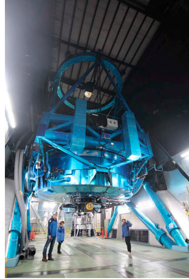
図2 観測前、すばる望遠鏡ドーム内で、左から共同研究者の高木氏、大朝氏、筆者。カセグレン焦点に搭載されている装置がMOIRCS。すばる望遠鏡の大きさが少しでも伝わるだろうか。
