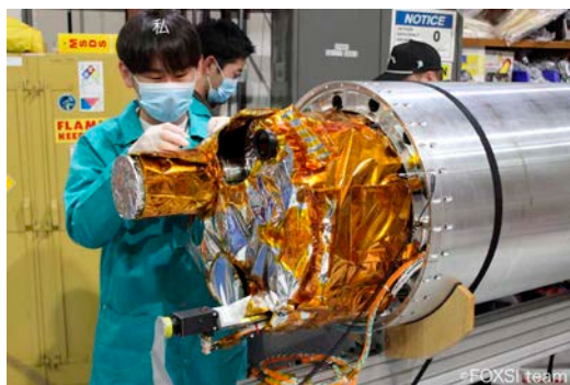
熱制御用フィルターを望遠鏡に取り付けている様子。
