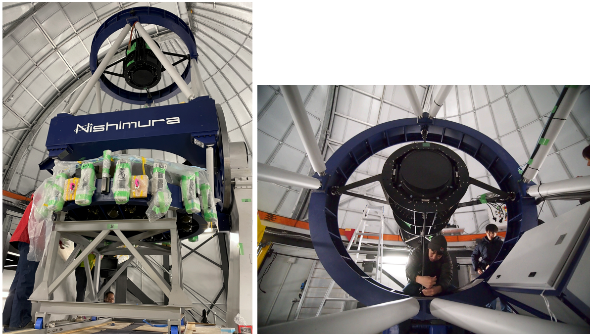
図 1: (左図) 建設途中の PRIME 望遠鏡。主鏡をマウントしているところ。望遠鏡上部の主焦点部にレンズ光学系とカメラがマウントされる。(右図) 主焦点部スパイダーのネジを調整する申請者。主焦点部の tilt, decenter を調整することで、光学系の調整をする。
