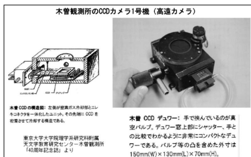
図1 高遠 CCD カメラの模式図 (左) と実物写真 (右) (木曾観測所 40 周年記念誌より)。
