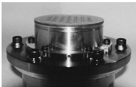
図2 研磨前の37素子ピエゾ駆動可変鏡。
