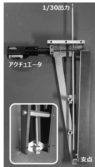
図3 セグメント鏡を駆動するアクチュエータと減速器。支点部分に捻りバネを使うことで高い直線性を実現した。
