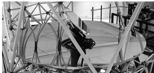
図1 せいめい望遠鏡の分割主鏡。
