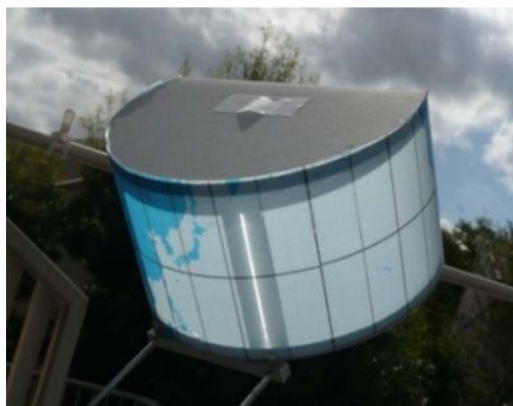
図7 シリカエアロゲルの円柱レンズを使った日時計。円柱レンズでできた太陽像（直線）を円筒上のスクリーンに映して時刻を読む。これにメルカトル図法の世界地図を描いておけば、太陽が南中している地点の経度を示すことになる。
