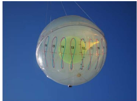
図1 完全球対称日時計 左：プラスチックの球形レンズの周りを水の球殻で囲ったものに平行光線を当てた時の光路図。右：この原理を使った日時計。外殻表面にアナレンマの時刻線が描いてある。
