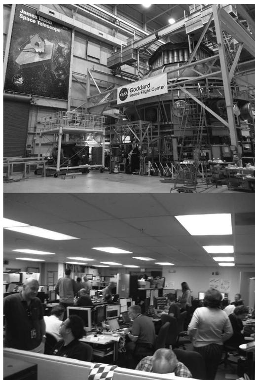
図1 ゴダード宇宙飛行センターでのCV試験の様子。1960年代に作られた極低温真空チェンバー(上)と、混み合ったコントロールルーム(下)。
