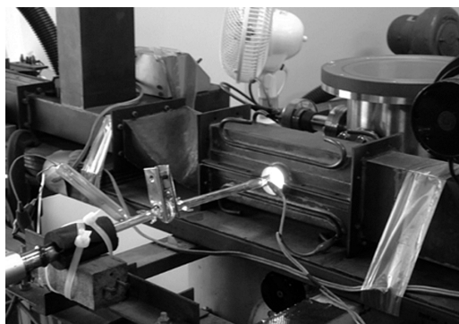
図2 2.45 GHzマイクロ波電源プラズマ発生装置を用いて, 急冷窒素含有炭素質物質 (QNCC) の合成を行う様子。
