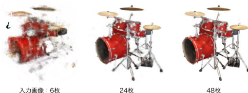
図6 NeRFによる新規視点画像合成の様子。入力画像枚数6, 24, 48枚の場合の結果。
