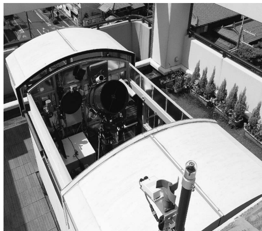
図1 ルーフバルコニーに設置したスライディング ルーフと 30 cmF4 ニュートン。 視界は地平線までありますが市街地のため低 空は撮影に向きません。
