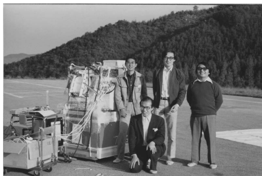
図1 三陸での気球実験(1976年)。発泡ポリウレタン断熱の液体窒素冷却屈折望遠鏡で近赤外線観測を行った。
