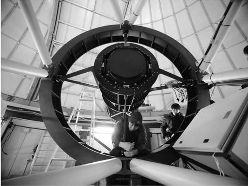
主焦点部スパイダーのネジを調整する筆者。主焦点部のtilt, decenterを調整することで、光学系の調整をする。
