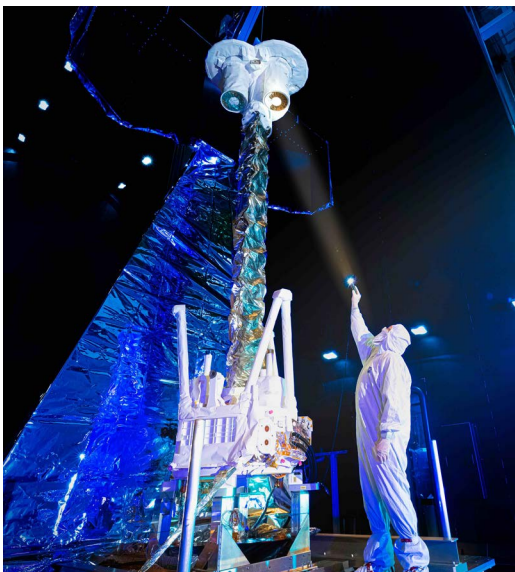
図5 進展ベンチ展開試験中のIXPE衛星 (c) Ball Aerospace
