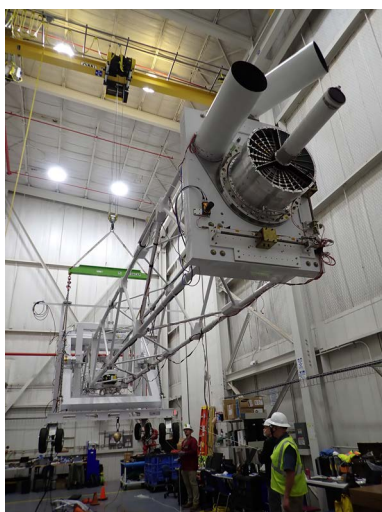
図6 NASAで組み合わせ試験中のXL-Calibur気球実験の全体像。手前に日本製の硬X線望遠鏡、焦点距離である12 m奥に偏光計を搭載する。
