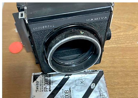
写真2 新星搜索用改造ポラロイドカメラ
