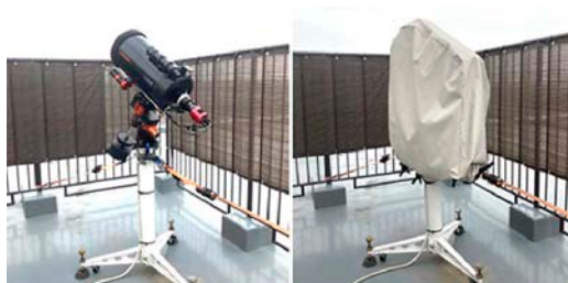
写真1 左：搜索機の設置状況、右：高耐候カバーで保管。
