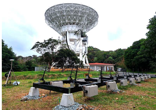
図7 BURSTT小笠原サブステーションのアンテナ群（手前）。台湾のBURSTTメインステーションと干渉計として使用すれば、その基線長は2000kmとなり、FRBの位置決定精度は0.1秒角以下となる。
