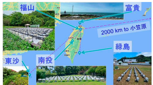
図6 台湾国内のBURSTTサブステーション。福山（256台）、南投、綠島（それぞれ64台）のアンテナはすでに設置済み。
