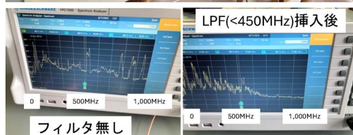
図4 (上) スペクトラムアナライザと作製したモノポールアンテナによるRFI確認の様子。(左下) 福井工業大学福井キャンパスにおける平日日中のRFI確認結果。非常に多くの人工電波が飛び交っていることがわかる。(右下) LPFをアンテナと初段のLNAに挿入した結果。450 MHz以上のRFIが抑制されていることが確認できる。
