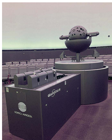
図6 コスモプラネタリウム渋谷のプラネタリウム投影機GEMINISTARIUM III (コニカミノルタプラネタリウム製)
