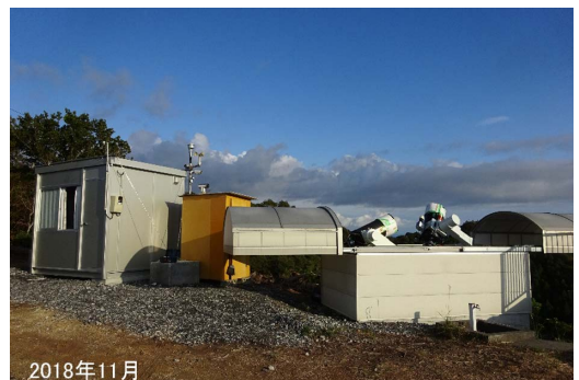
写真4 高知の望遠鏡（本人提供）。0.35-m F/11+CCD（KAF-1001E）2台を搭載。
