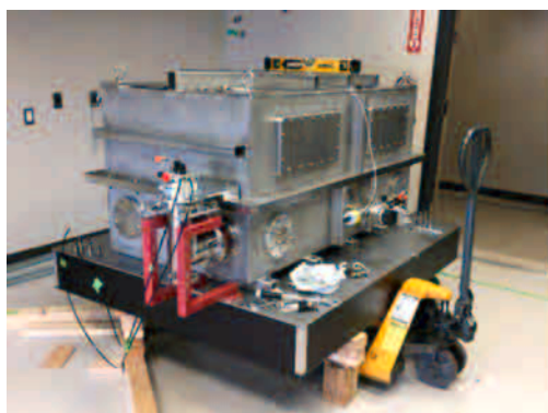
図2 (左) IRDの真空チャンバーの外観。大きさは約1.5×1 mです。(右) 真空チャンバー内部に格納されている分光器光学系とそれを囲む、常温部からの輻射をカットする輻射シールド。クレジット：ABC
