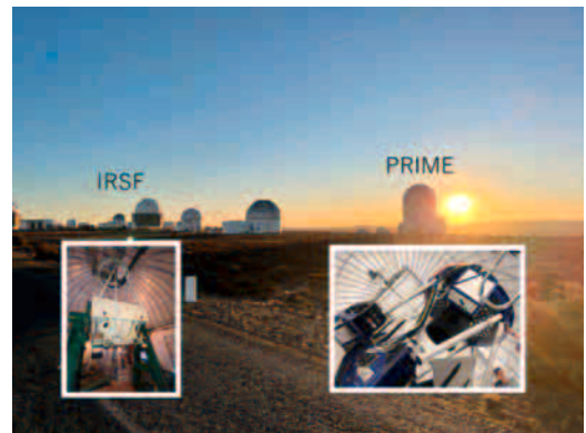
図6 PRIMEとIRSF望遠鏡。SANDはPRIME望遠鏡ドームに隣接した部屋に設置されます。PRIMEとIRSFを光ファイバーで結合する計画を進めています。クレジット: ABC
