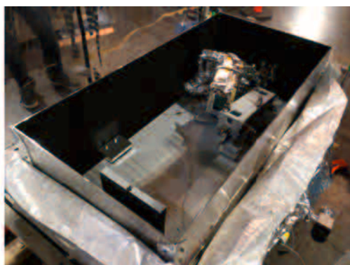
図2 (左) IRDの真空チャンバーの外観。大きさは約1.5×1 mです。(右) 真空チャンバー内部に格納されている分光器光学系とそれを囲む、常温部からの輻射をカットする輻射シールド。クレジット：ABC
