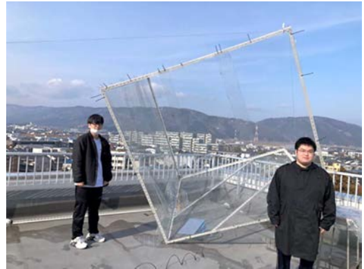
図6 完成した3DCRの設置状況. 北に向けた3DCRの仰角を B0329+54 の北中高度に固定している.
