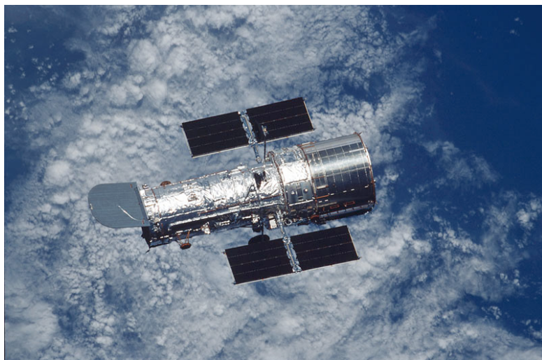
図2：アメリカ宇宙望遠鏡機構が運営する、口径 2.3 m のハッブル宇宙望遠鏡。大気の影響を受けない宇宙空間から観測します。
