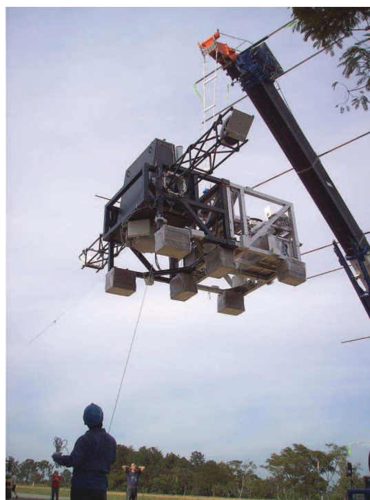
図2:我々が製作中の宇宙遠赤外線干渉計。気球を使って地上3.5万mまで上昇させて観測します。
