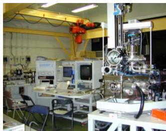
広島大学理学部棟内に設置されているイオンマイクロプローブ SHRIMP
