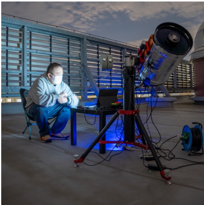
図2: PONCOTS 観測システム。 京都大学吉田キャンパス(京都府京都市左京区)の施設屋上に設置して木星の動画モニタ観測を実施した。
