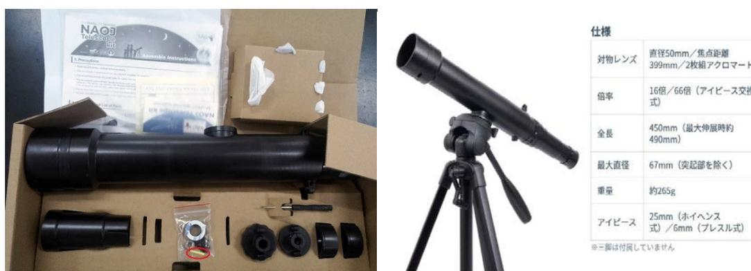
図1 教具として開発した「国立天文台望遠鏡キット」（左：組立前、右：組立後）
