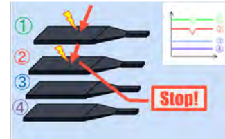
図2：μ粒子が入射し、その後停止する様子
