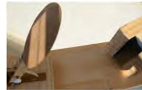
図2 景筐を逆向きにして光を遮り、圭面に横梁の像を明瞭に映す
