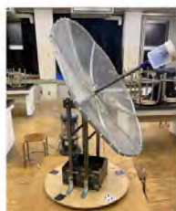
図1:製作した電波望遠鏡
