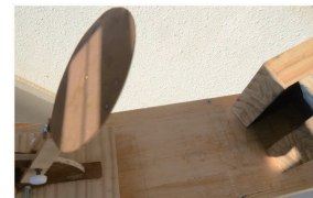
図2 景筒を逆向きにして光を遮り、圭面に横梁の像を明瞭に映す
