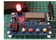
図2 LED調光器(光の三原色実験器)
