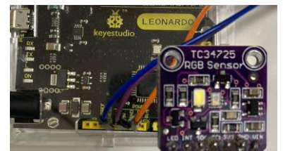
図8 カラーセンサ(TCS34725)基板とマイコンボード
