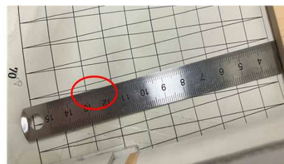
図2 1度毎に引かれた主尺の間の副尺(斜線)と定規の交点を読む(図の場合は21.25度)。
