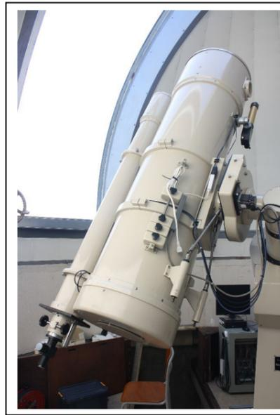
図 2 西村製作所の 40cmF5 ニュートン式反射望遠鏡
