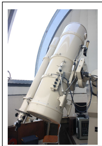
図 2 西村製作所の 40cmF5 ニュートン式反射望遠鏡
