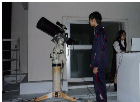
図1.分光器とCCDカメラを接続した望遠鏡
