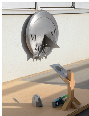
図3 太陽像の位置を記録して正確な方位を調べる装置
