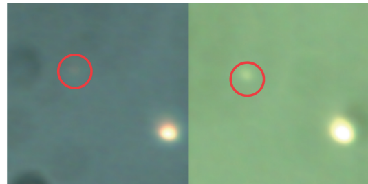
図1 CMOSカメラで撮影した昼間の5等星(円内) 左)C-PLフィルターなし 右)C-PLフィルターあり
